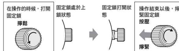
※ 在擰緊固定鎖的時候，要注意螺絲的啮合狀態，慢慢地按壓著擰緊。如果過於用力按壓，則有可能損壞螺絲部 (錶殼)。需要注意！
