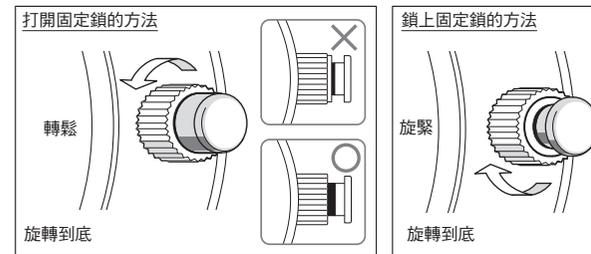
逆時針擰動按鈕環 (6 點鐘方向)，逐漸使滑蓋下滑。將按鈕環旋轉到底，直到可以清楚看見確認線，並且按鈕環無法再轉動時，即可開始進行操作。
