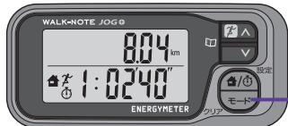
計測停止中に[モード]を押します。
