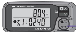
計測停止中に[モード]を押し続けます。
