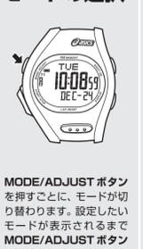
MODE/ADJUST ボタンを押すことで、モードが切り替わります。設定したいモードが表示されるまでMODE/ADJUST ボタンを繰り返し押してください。
