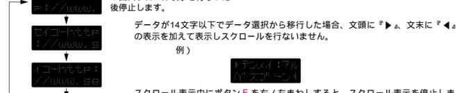
スクロール表示中にボタンEを右/左まわしすると、スクロール表示を停止します。更にこの状態でボタンEを右/左まわししますと、それぞれ1文字送り/戻しとなります。右/左まわしを保持しつづけると、連続して表示をそれぞれ送り/戻しします。
