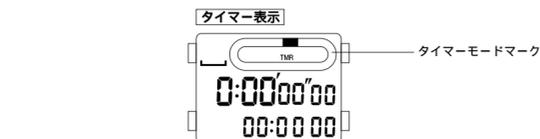
ボタンBを押すと[タイマー時間合わせ]となり時桁が点滅します。
