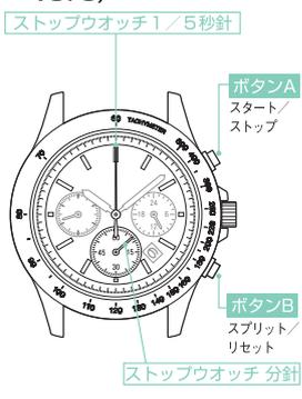
V176は、1/20秒単位で最大60分まで計測できます。60分経過後は、0分0秒位置に針が停止し計測がリセットされます。
