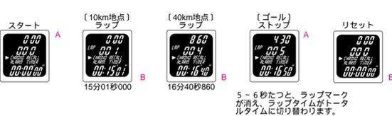
ラップ計測後5～6秒間放置しますと、自動的に計測表示にもどります。
