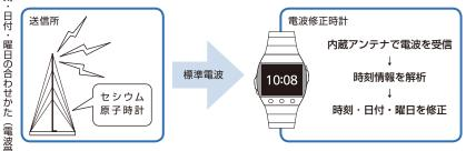
(電波受信 標準電波の時刻情報は、およそ10万年に1秒の誤差という 超高精度を保つ「セシウム原子時計」によるものです。
