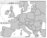
NPL (国立物理学研究所) により運用されています。 カンブリア州北西: アンソーン送信所: 60kHz \*\* NPL: National Physical Laboratory
