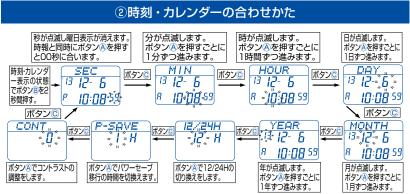
※分・時・日・月・年の修正で数字を早送りしたい場合は、ボタン係を押し続けてください。押し続けている間、早送りします。 ※ボタン像を押すと時刻・カレンダー修正を解除します。 押し忘れた場合でも2~3分後には時刻・カレンダー修正を解除します。 ※年・月・日に合わせると自動的に曜日がセットされます。 ※時刻・カレンダー修正状態で、ボタン係とボタン©を同時に押しますと全点灯表示します。故障ではありません。
