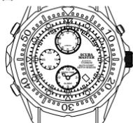
潜水時間は「潜水時間針」で示します
