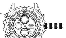
ボタンBとボタンCは同時に押さないでください。ボタンCを押して、1/10m針と深度針および最大深度針を0位置(0.0m)に合わせます。1/10m針と深度針は連動しています。1/10m針が1周すると、深度針が1m進みます。最大深度針は置き針式なので、深度針から右回転方向に押された場合にのみ動きます。最大深度針を深度針で連れて行き「0.0m」位置に合わせてください。
