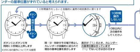
※カレンダー位置の微調整は「30」または「31」で停止させ、数字と窓の位置を確認することをおすすめします。その後、位置のずれをボタン®で微調整するときちんと合わせられます。
