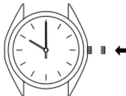
時報と同時にリュウズを押し込んでください。時刻合わせは完了です。ネジロックタイプのモデルはリュウズを押しつけながら右に止まるころまでネジ込んでください。
