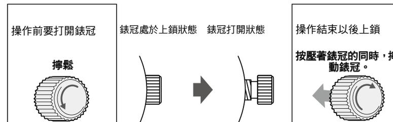
\* 鎖住錶冠時，輕輕轉動，注意螺絲的啮合。注意不要用力按壓，這樣做可能會損壞錶殼上的螺絲孔。
