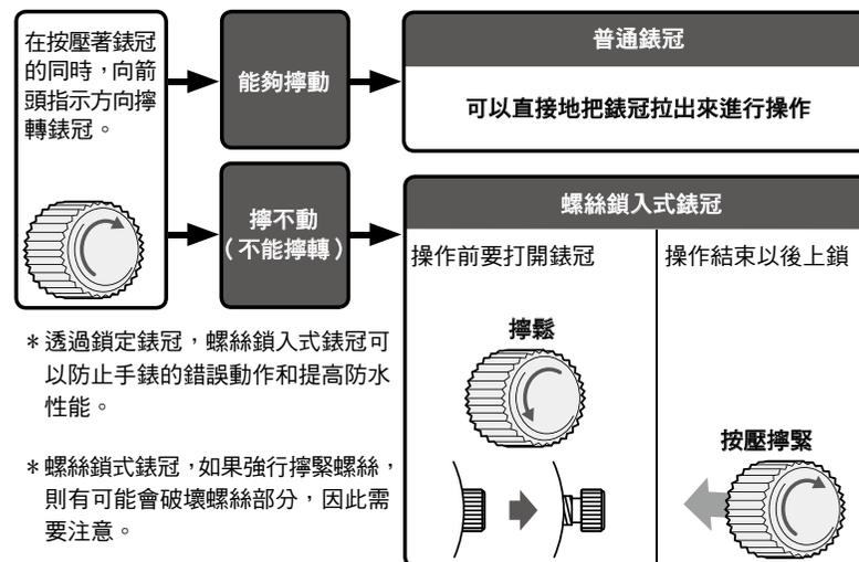
\* 透過鎖定錶冠，螺絲鎖入式錶冠可以防止手錶的錯誤動作和提高防水性能。
