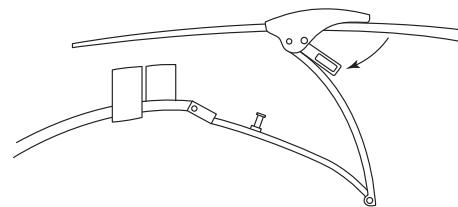
3 ピンをアジャスト穴から外します。バンドを左右にスライドさせ、適切な長さのところで、ピンをアジャスト穴に入れます。
