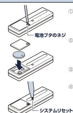
①市販の小型⊕ドライバーで電池ブタの ネジをはずします。ネジをなくさないようにご注意ください。
