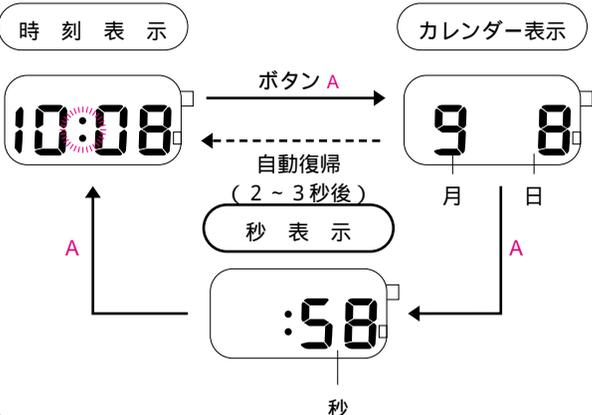
カレンダー表示から時刻表示には、自動的にもどります。カレンダー表示のときボタンAを押すと秒表示になります。秒表示から時刻表示には自動的にもどりません。ボタンAを押して、もどしてください。時刻表示のとき、ボタンBを1回押すと「時刻表示」と「カレンダー表示」が2秒間隔で、交互に表示されます。通常の時刻表示にもどすには、ボタンBを5回押してください。
