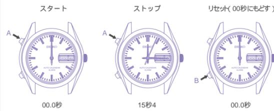
時間計測を積算で行う場合（例：バスケットボール）ボタンの押す順序：A A A... A B）ボタンAを押すごとに、ストップと再スタートをくり返すことができます。
