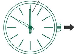
止まっていたように見える時計が目覚め、まず最初に時分針だけが早送りして回路が記憶している時刻を示します。
