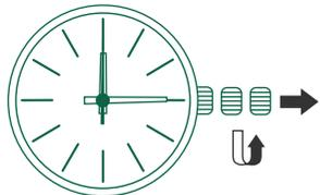
①秒針が12時(0時)位置にきたら、リュウズを2段階目まで引き出してください。リュウズが引き出せない(ネジロック式リュウズ)モデルはリュウズを左に回してネジをゆるめリュウズを2段階引き出してください。(秒針が止まります。)
