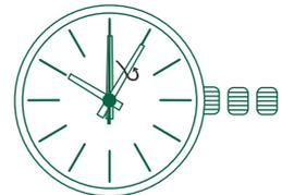
②リュウズをまわして針を合わせてください。クォーツは機械時計と機構が異なりますので時計の構造上、分針を合わせる時刻より一旦4~5分進めてから逆にもどすようにして合わせてください。時刻合わせは、電話の時報サービスTEL.117が便利です。
