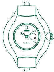
正確に合わせるためには、分針を合わせる時刻より4～5分進めてから逆に戻して合せてください。この時計は20秒に1回、分針を動かしています。
