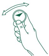
「起動インジケータ」が確認しやすいように、止まっている時刻をよく確認しておきましょう。ここで振る「約50回（往復）」は合計50回ではなく連続で振っていただくと、「起動インジケータ」がより確認しやすくなります。1秒間に2往復の早さで、約20cm位の距離を往復させるように振っていただくと、最も効率的です。極端に早く激しく振っても効率の良い充電はできません。発電機を回す音が聞こえますが、異常ではありません。
