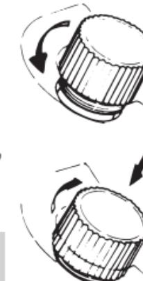
\* 鎖定錶冠時，注意要慢慢地轉動，以保證螺絲齒能完全吻合。不可過度用力推入，以免損傷錶殼內的螺絲孔。
