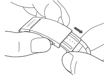
**2** 掀起安全盖，在按住按压按钮进行连接和分离的同时，提起外盖，松开表扣，然后将手表戴在手腕上。
