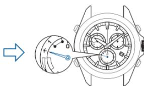
如果处于飞行模式( $\times$ )状态的话，则指示器指针不会显示出“电池残量”。
