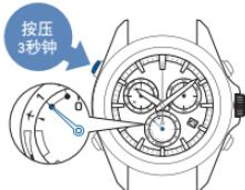
\* 当指示器指针指示在“少”或
