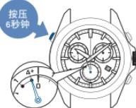
※ 当指示器指针指示在“少”或
