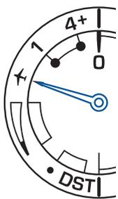
※ 解除飞行模式(✈)的时候，则指示器指针将显示电池残量。
