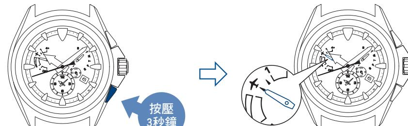
飛航模式下，指示器指針無法顯示電池蓄電量。
