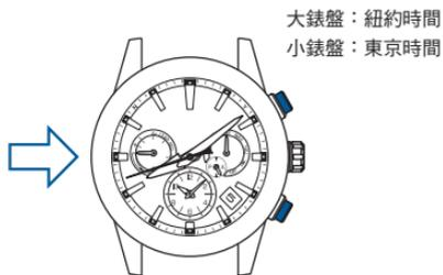
秒針指出切換的基準時間之時區。指示針指出切換的基準時間之 DST（夏令時間）設定狀態。之後，大錶盤的時針和分針、小錶盤、日期和星期日期會依序切換。最後，秒針會回到時間顯示，指示針會回到充電狀態顯示。
