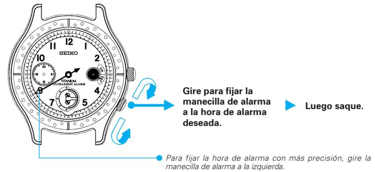
Para fijar la hora de alarma menos de 2 horas por delante de la hora actual, primero avance la manecilla de alarma más de 2 horas por delante de la hora actual y, luego, gírela de nuevo a la hora de alarma exacta.
