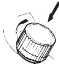
\* Drehen Sie die Krone beim Verschrauben langsam und vorsichtig. Achten Sie darauf, dass das Gewinde richtig fasst. Schrauben Sie sie nicht unter Kraftaufwendung ein, weil dadurch das Gewinde im Gehäuse beschädigt werden kann.
