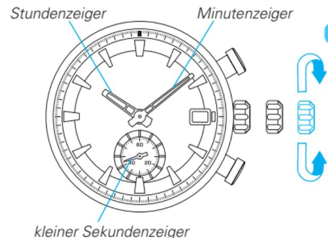
**KRONE** Bis zur 2. Einrastposition herausziehen, wenn der kleine Sekundenzeiger auf der Position 12 Uhr ist.
