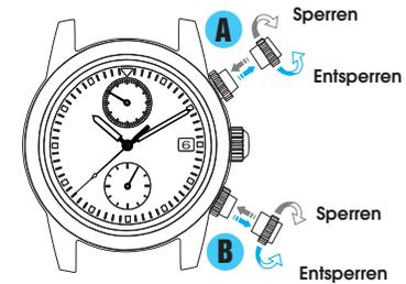
**Sperren der Drucktaste**
