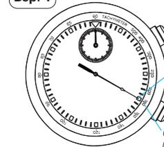
"180" (Wert auf Geschwindigkeitsmesserskala) x 1 Vorgang = 180 Vorgänge pro Stunde
