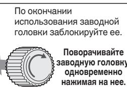
\* При блокировке заводной головки поворачивайте ее аккуратно, чтобы винт должным образом входил в зацепление с резьбой. Соблюдайте осторожность и не нажимайте на заводную головку с усилием, иначе можно повредить отверстие под винт в корпусе.
