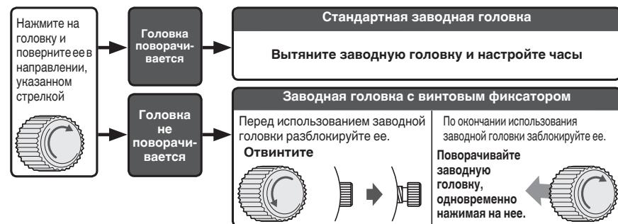
\* При закрытии заводной головки с помощью фиксатора можно предотвратить возникновение неисправности и упрочить водонепроницаемость часов.
