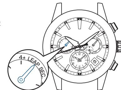
Una volta completata la ricezione dei dati del secondo intercalare, la lancetta indicatrice torna a visualizzare lo stato della carica. Usare l'orologio così com'è.
