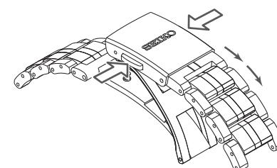
2 Serrare il fermaglio premendo sulla struttura della chiusura.
