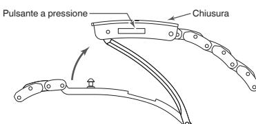
2 Serrare il fermaglio premendo sulla struttura della chiusura.
